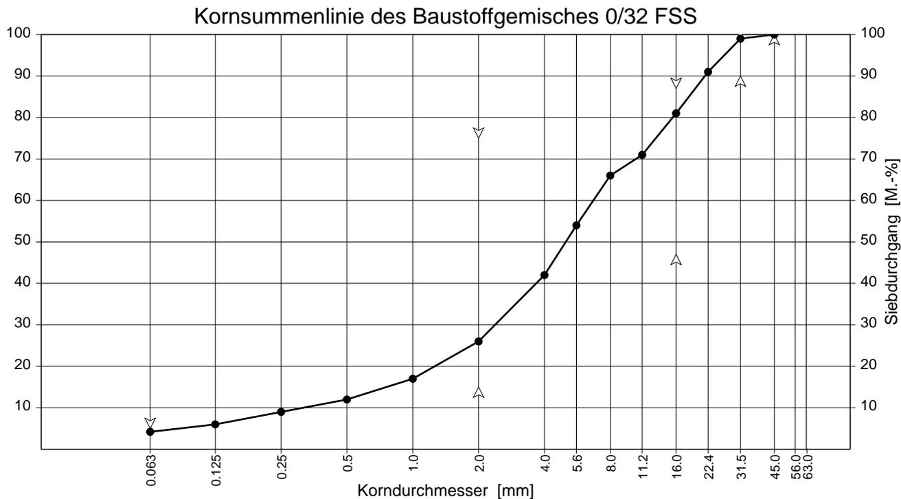
Das untersuchte Material 0/32 FSS entspricht hinsichtlich der Kornverteilung den Anforderungen der TL SoB-StB an ein Baustoffgemisch für Frostschutzschichten.
