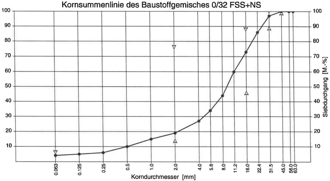
Das untersuchte Material 0/32 FSS+NS entspricht hinsichtlich der Kornverteilung den Anforderungen der TL SoB-StB an ein Baustoffgemisch für Frostschutzschichten.
