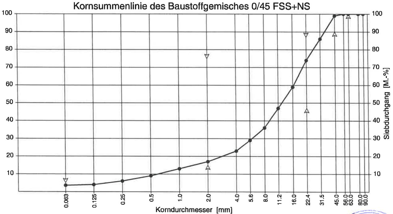
Das untersuchte Material 0/45 FSS+NS entspricht hinsichtlich der Kornverteilung den Anforderungen der TL SoB-StB an ein Baustoffgemisch für Frostschutzschichten.
