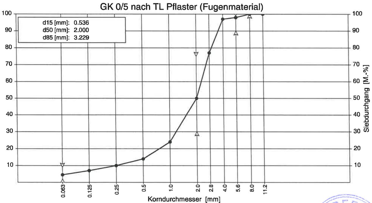
Das untersuchte Baustoffgemisch 0/5 ist gemäß TL Pflaster-StB hinsichtlich der Kornzusammensetzung als Fugenmaterial einsetzbar.
