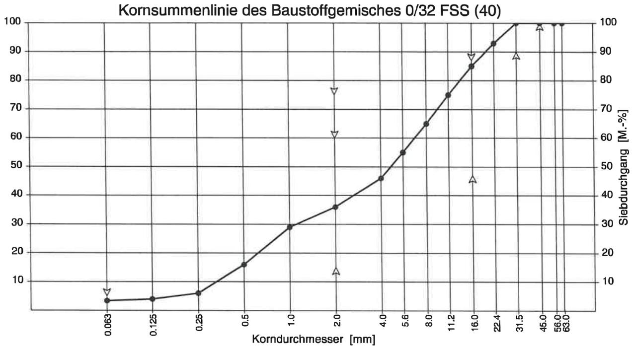
Das untersuchte Material 0/32 FSS (40) entspricht hinsichtlich der Kornverteilung den Anforderungen der TL SoB-StB an ein Baustoffgemisch für Frostschutzschichten.
