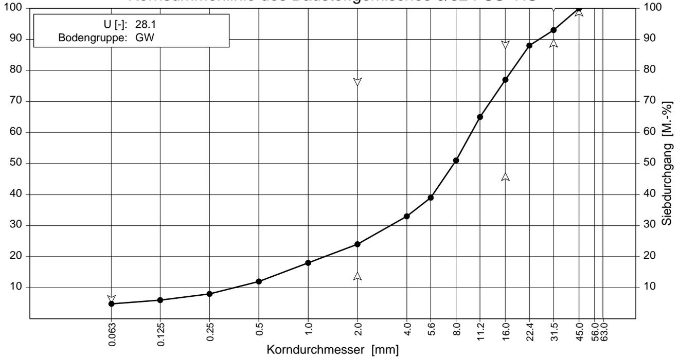
Das untersuchte Material 0/32 FSS+NS entspricht hinsichtlich der Kornverteilung den Anforderungen der TL SoB-StB an ein Baustoffgemisch für Frostschutzschichten.
