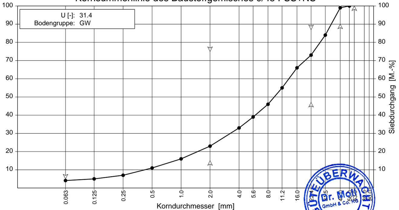
Das untersuchte Material 0/45 FSS+NS entspricht hinsichtlich der Kornverteilung den Anforderungen der TL SoB-StB an ein Baustoffgemisch für Frostschutzschichten.
